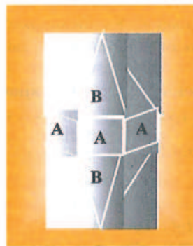
Fig. 3. Këndet reciprok të rrafsheve fqinjë te të gjithë monokristalet e substancës së njëjtë janë të barabartë
